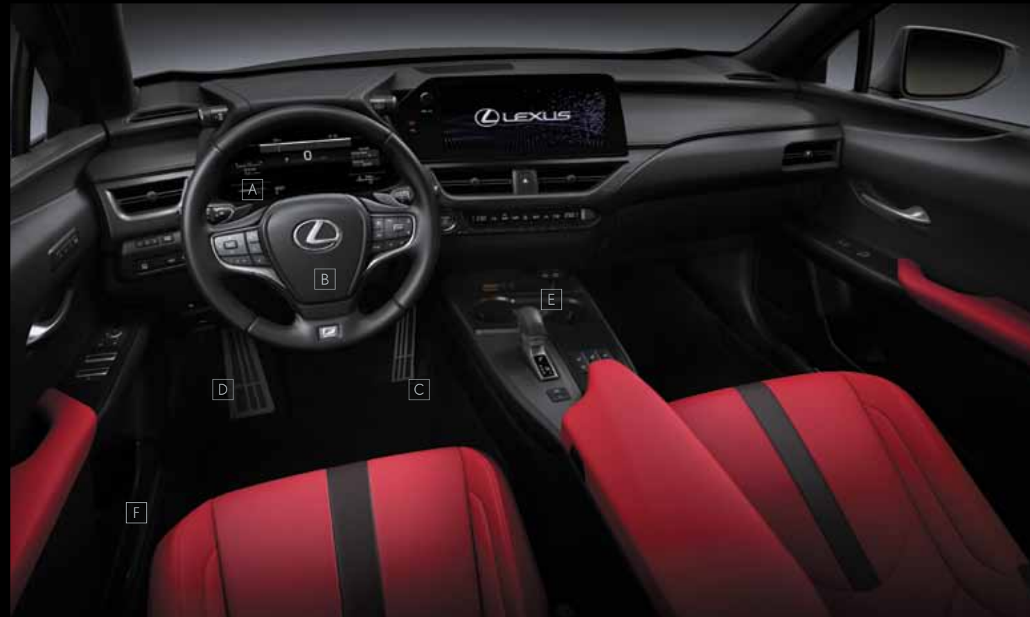
A_عدادات وشاشة عرض المعلومات المتعددة / B_عجلة القيادة / C_دواسات الألمنيوم / D_مسند القدم الألمنيوم / E_مقبض ذراع النقل / F_لوحات العتبة
